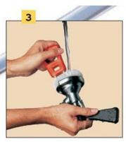
Fitting und Zapfkopf mit fließendem Wasser und den hierfür bereitgelegten speziellen Bürsten reinigen.
