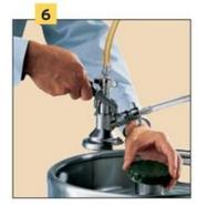
Zum Abnehmen des Zapfkopfes ziehen Sie den Hebel nach oben und nehmen den Zapfkopf vom Verschluss. Danach Schutzkappe wieder auflegen.
