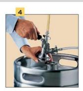
Schieben Sie den Zapfkopf mit den angeschlossenen Bier- und Kohlensäureleitungen bis zum Anschlag über den Verschluss. Beim Korbfitting (s. Foto rechts) dagegen wird der Zapfkopf auf den Verschluss aufgesetzt und durch Drehung verbunden. Das Kombifitting entspricht in der Handhabung dem Flachfitting.
